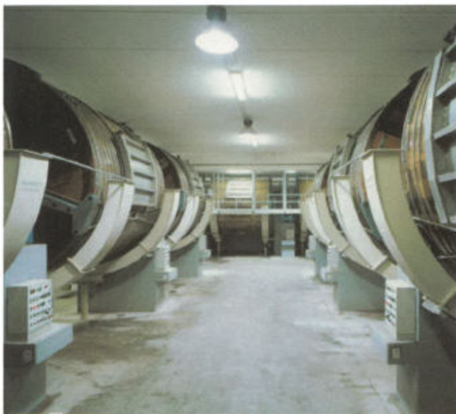
Un reparto per le lavorazioni di concia in bottale
