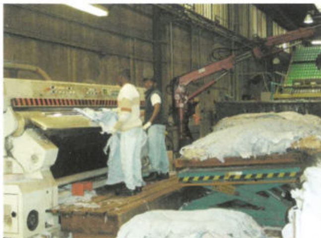
La rasatura di pelli conciate al cromo
